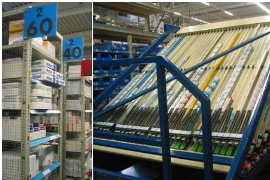
Fachboden regal (links), Kommissionierautomat (rechts)
